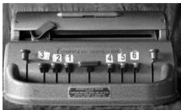
Slika 21: Brailleov pisaći stroj Perkins
